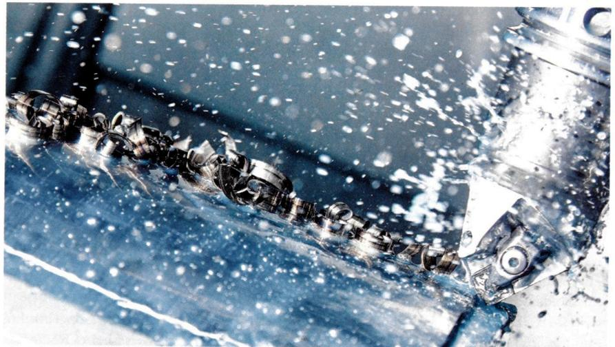
**Bild 1** Ein Plus für produzierte Teile: Mit dem wasserbasierten KSS bleiben ihre Oberflächen fettfrei. Ein Plus für die Umwelt: Metallspäne sind dank ‚Aquaslide‘ nicht länger ölbehaftet - und müssen demnach auch nicht als Sondermüll entsorgt werden. Foto: polsterpics.com
